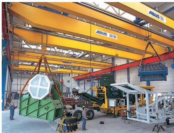
Zo goed als slingervrije montage van grote machines
