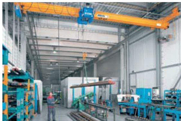
Kortgebouwde loopkat type E aan een onderhange- de loopkraan EDL.
