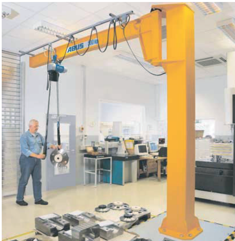
Kolomzwenkkraan LSX met elektrische kettingtakel ABUCompact GM2
