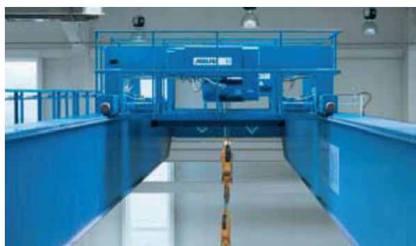
Met borden aan de kat bijzonder onderhoudsvrien- delijk: het ABUS elektrostaaldraad- takel, type DB.
