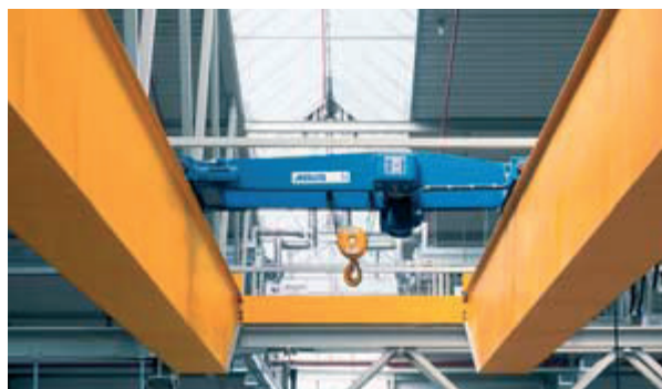
Met een ABUS elektrostaaldraad- takel type DQA wordt de inbouw- maat aanzienlijk gunstiger.
