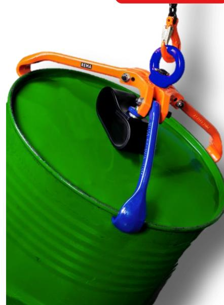
**Zvieracia čeľusť REMA DG10 má pracovné povolené zaťaženie (WLL) 1 tonu.** Nikdy neprekračujte WLL zvieracej čeľuste REMA DG10 alebo použitého zdvívacieho zariadenia. Vždy poznejte hmotnosť nákladu, ktorý zdvívate. Zdvíhanie a presúvanie ľahkých nákladov môže byť nebezpečné. Budete opatrny a dávajte pozor na to, čo robíte. Sledujte a vyhýbjte sa nebezpečenstvám.
